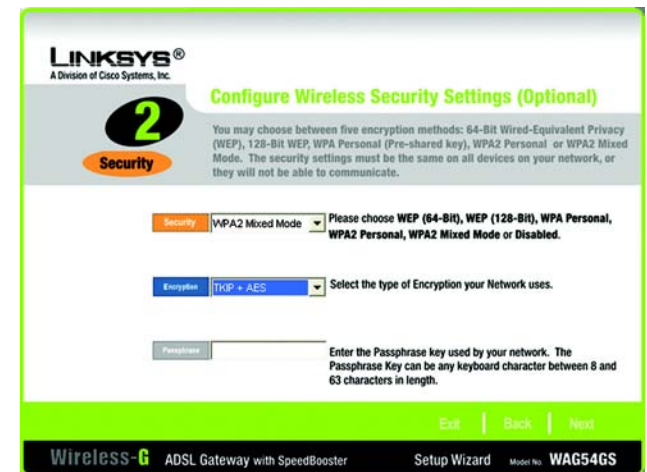
Abbildung 5-29: Setup-Assistent – Fenster Configure Wireless Security Settings (Optional) (Konfigurieren der Wireless-Sicherheitseinstellungen [optional]) – WPA2 Mixed Mode (WPA2 Gemischter Modus)
